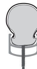
Figura 17. Verificare che la camera d'aria non resti incastrata sotto i talloni dello pneumatico.
