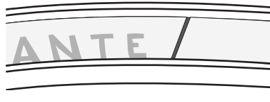
Figure 8. Ne chevauchez pas les deux extrémités du ruban de fond de jante.
