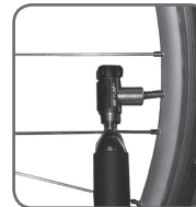
Ilustración 5. Inflado de la cubierta con el cartucho en posición vertical
