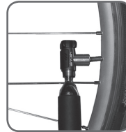
Figure 5. Gonflage du pneu avec la cartouche en position verticale
