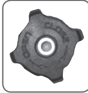
Ilustración 2. Válvula del AirRush: gírela hacia la derecha para cerrarla
