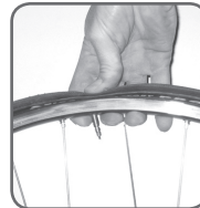
Abbildung 4: Druck auf Reifen ausüben, um Ventil herauszudrücken
