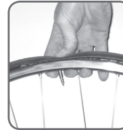
Ilustración 4. Apriete la cubierta para que sobresalga la válvula
