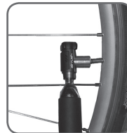
Abbildung 5: Beim Aufpumpen Kartusche in aufrechter Position
