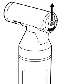
Figura 6. Bloqueo de deslizamiento en posición de desbloqueo (hacia arriba)
