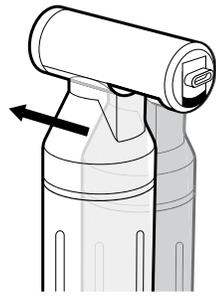
**Figura 7. La lata se desliza hacia la válvula para realizar el inflado**
