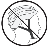
ภาพที่ 2 ตำแหน่งของหมวกนิรภัยที่ผิด
