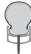
Figura 17. Certifique-se de que a câmara interna não está presa sob os talões do pneu.
