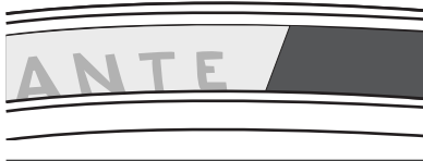
Figura 6. Inicie a instalação da fita de aro centralizada entre os nós de raios.
