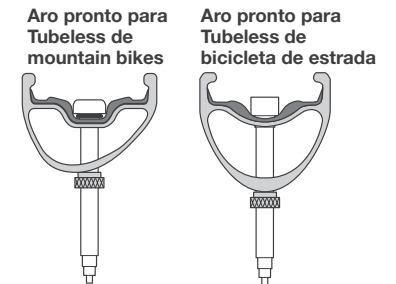
Figura 11. Coloque a válvula pronta para Tubeless através da fita de aro e do aro.
