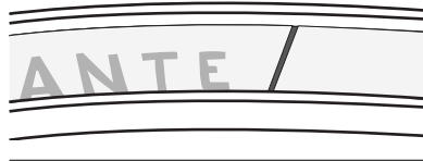
Figura 8. Não sobreponha as extremidades da fita do aro.
