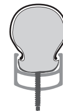
Abb. 17. Darauf achten, dass der Schlauch nicht unter den Reifenwulsten eingeklemmt ist.
