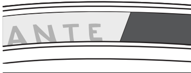
Abb. 6. Den Anfang des Felgenbands zwischen zwei Speichenlöchern positionieren.
