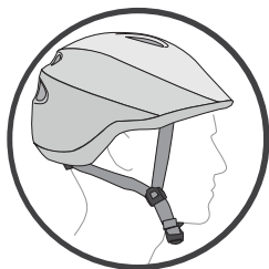
Figuur 1. Juiste plaatsing van de helm
