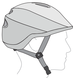
Figuur 8. Juiste plaatsing van het kinbandje
