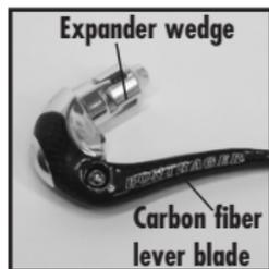
Figure 1- Bontrager Race XXX Lite aero brake lever
